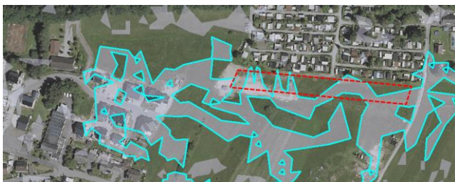
Abb. 17: nach TWI ermittelte Agrothermieflächen (hellblau) nach der Berechnung der Spannweite (R) nach Bahrenberg; Lage Agrothermieanlage (rot)
