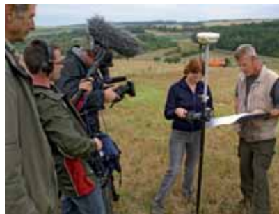
Mittels modernster Technik (GPS) wurden die neuen Grenzpunkte in der Flurneuordnung Bad Mergentheim-Löffelstelzen im Herbst 2008 in die Örtlichkeit übertragen.
